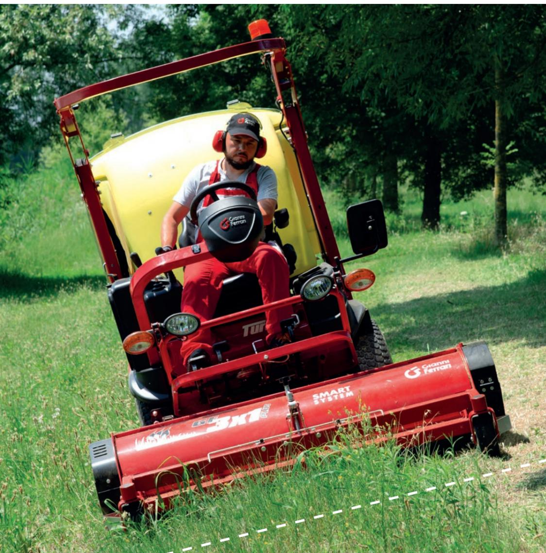
Turbo 4 má zadnú nápravu s ozubenými kolesami v olejových kúpeľoch v kombinácii s hydraulickým piestovým motorom s variabilným objemom.
